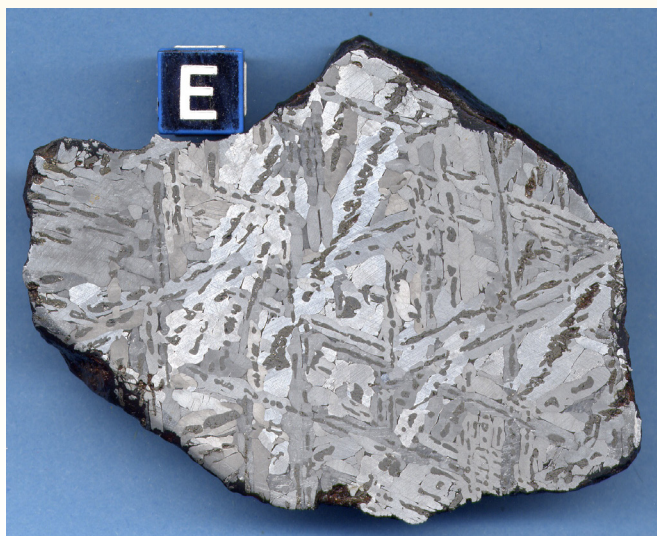
Fot. 2. Morasko z cohenitem. Powierzchnia przekroju wytrawiona. Kostka ma bok 1 cm
