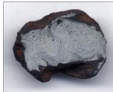
Przekrój drugiego znaleziska po wytrawieniu. Niestety to tylko żeliwo.
