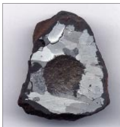
Pierwsze znalezisko po zeszlifowaniu powierzchni i wytrawieniu.
