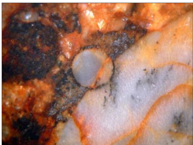
Fot. 2. Dowód na małą chondrę uderzającą w dużą. Pole widzenia ma 0,43 mm szerokości. Światło odbite przy skrzyżowanych polaroidach. Fot. Tom Phillips.
