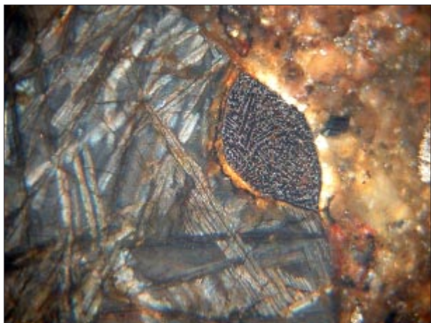
Fot. 3. Dowód na to, że kraterki zostały wytworzone przez wyrzucanie inkluzji metalu i siarczku z krzepnących chondr. Budowa wskazuje, że ta bryłka jest mieszaniną eutektyczną żelaza i troilitu. Pole widzenia ma 0,80 mm szerokości. Światło odbite przy skrzyżowanych polaroidach. Fot. Tom Phillips.
